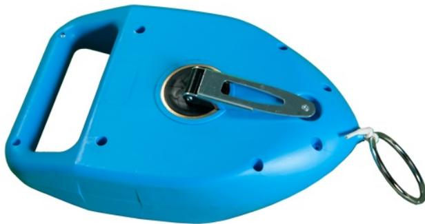
Schnüre werden im Dachstuhl für die Vorbereitung der Verlegearbeit und das Anzeichnen des Dachlattenabstands verwendet.
